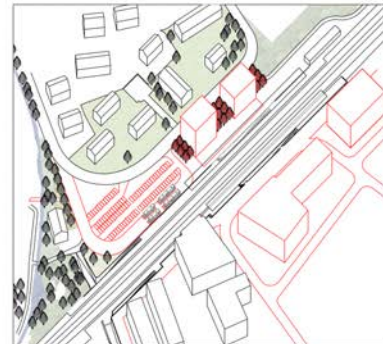
3. Etappe (ca. 2029 - 2031): Zentrum Bahnhof Ost • Verlängerung Bahnhofstrasse und prov. Buskanten West • Erstellung Bau 1 und 2 mit Tiefgarage und Aussenbereichen • Umorganisation P+R und Veloabstellplätze
